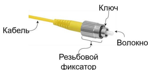
Рисунок 3 Части оптоволоконного разъема FC/PC
